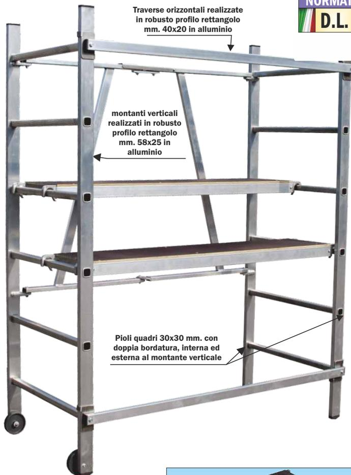
ALUMINI è un mini ponteggio ideato per lavorare in modo semplice, rapido ed efficace in locali interni o su superfici pianeggianti. I collegamenti delle traverse orizzontali e utilizzano un dispositivo anti-distacco che permette un'installazione rapida ed un utilizzo sicuro. Il telaio pieghevole permette un montaggio immediato con grande facilità e le ruote consentono un comodo spostamento a carriola sia quando montato che quando viene riposto.
